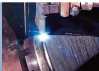
Auftragsschweißung einer Axialwalze mit UTP AF DUR 550 MP
