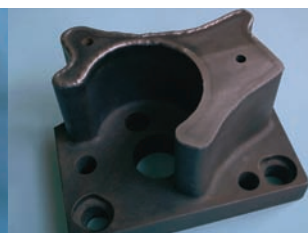
Kantenauftragung an Schnittbacken aus I.3343 mit UTP 690
