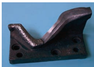
Formänderung an Schnittbacken aus I.2382 mit UTP 73 G 2
