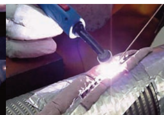
WIG-Reparatur einer Räumnadel mit UTP A 696
